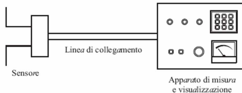
Struttura tipica di un apparato per misure a RF e MW.
